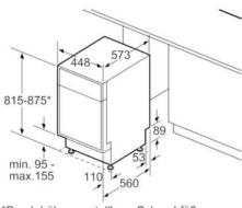
\*Durch höhenverstellbare Schraubfüße Sockelhöhe bei Gerätehöhe 815: 95 mm Sockelhöhe bei Gerätehöhe 875: 155 mm Maße in mm
