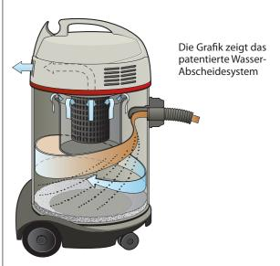
Durch den Drall am Einlassstutzen wird der Sprühnebel an der Behälterwand abgeschieden. Zusätzliche Filterstoffe sind nicht mehr notwendig. Die zuverlässige Schwimmerabschaltung reagiert selbst bei extremer Schaumbildung. Seitliche Kühl-Luftschlitze sorgen für konsequente Trennung von Kühl- und Prozessluft.
