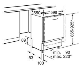
\* Durch höhenverstellbare Schraubfüße Sockelhöhe bei Gerätehöhe 865 90-160 mm Sockelhöhe bei Gerätehöhe 925 150-220 mm
