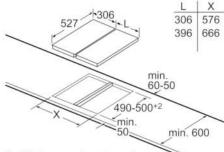
Bei Einbau zweier oder mehrerer Domino-Elemente direkt nebeneinander ist ein oder sind mehrere Montagesätze erforderlich (2 Elemente 1 Montagesatz, 3 Elemente 2 Montagesätze usw).
