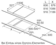
Bei Einbau eines Domino-Elementes direkt neben einer Mulde ist ein Montagesatz (HEZ394301) erforderlich.
