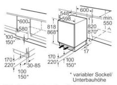
Platz für elektrischen Anschluß seitlich rechts oder links neben dem Gerät. Be- und Entlüftung im Sockel.
