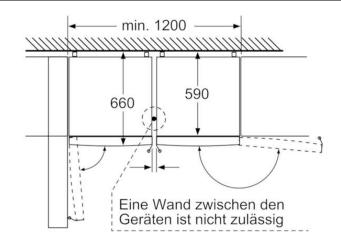
Die beiden dargestellten Geräte sind identisch. (Mit unterschiedlichem Türanschlag) Maße in mm
