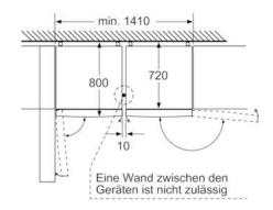
Die beiden dargestellten Geräte sind identisch. (Mit unterschiedlichem Türanschlag)
