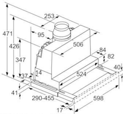
Tiefenanpassung des Filterauszuges bis 29 mm möglich
