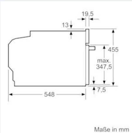
Wird das Kompaktgerät unter einem Kochfeld eingebaut, muss folgende Arbeitsplattenstärke (ggf. inkl. Unterkonstruktion) beachtet werden.
