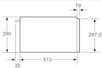
Über eine Wärmeschublade können Backöfen mit einer Gerätehöhe von 595 mm eingebaut werden. Ein Zwischenboden ist nicht erforderlich.
